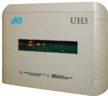
Regelverteiler (230 Volt) zur Steuerung von bis zu 8 Zonen. Zusatzfunktionen zur Steuerung von Umschaltventil, Pumpe und Warmwassergerät können wahlweise automatisch oder dauerhaft zugeschaltet werden. Der Betriebsstatus aller Heizzonen und Funktionen wird durch LED's angezeigt. Je Zone können bis zu 4 Stellantriebe (230 Volt) angeschlossen werden.
