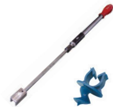
Die Clips sind eine alternative Methode zur Rohrfixierung von 15 mm Rohren in Polystyrolisolierungen. Sie werden mittels des JG Fixing Tools in die Isolierung geschraubt. Mit einer Gewindelänge von 25 mm sind sie für Polystyrolmatten mit einer Dicke  $\geq 25$  mm geeignet.
