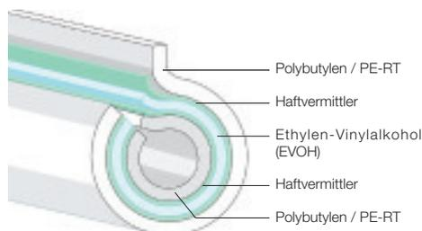
JG Rohre sind Mehrschicht-Verbundrohre mit 5 Schichten. Den unterschiedlichen Rohrarten liegt ein analoger Aufbau zu Grunde. Die innere und äußere Kunststoffschicht bestehen aus Polybutylen bzw. PE-RT. Die dazwischenliegende Sauerstoffsperrschicht wird aus EVOH-Kunststoff hergestellt, die mittels Haftvermittler - während des Fertigungsprozesses - mit den Polybutylen / PE-RT-Schichten verklebt wird.
