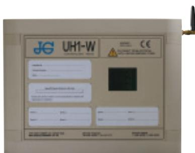
Funk-Regelverteiler (230 Volt) zur Steuerung von bis zu 8 Zonen. Zusatzfunktionen zur Steuerung von Pumpe oder Warmwassergerät können automatisch zugeschaltet werden. Der Betriebsstatus aller Zonen und Funktionen wird durch LED's angezeigt. Je Zone können bis zu 6 Stellantriebe (230 Volt) angeschlossen werden.
