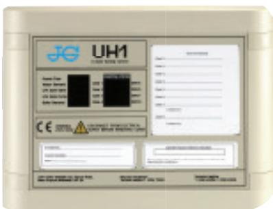
Netzwerk-Regelverteiler (12 Volt / 230 Volt) zur Steuerung von bis zu 8 Zonen. Zusatzfunktionen zur Steuerung von Umschaltventil, Pumpe und Warmwassergerät können wahlweise automatisch oder dauerhaft zugeschaltet werden. Der Betriebsstatus aller Heizkreise und Funktionen wird durch LED's angezeigt. Je Zone können bis zu 6 Stellantriebe (230 Volt) angeschlossen werden.
