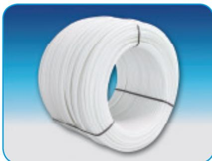
Flexibles 5-Schicht-Vollkunststoffrohr bestehend aus PE-RT nach DIN 16833 sowie einer Sauerstoffsperrschicht (EVOH) nach DIN 4726. Die innere und äußere Kunststoffschicht bestehen aus PE-RT. Die dazwischenliegende Sauerstoffsperrschicht wird aus EVOH-Kunststoff hergestellt, die mittels Haftvermittler - während des Fertigungsprozesses - mit den PE-RT-Schichten verklebt wird.
