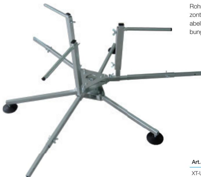
Rohrverlegehilfe mit Bremse. Tragbare und zusammenklappbare horizontale Abrollvorrichtung für 200 - 600 m Ringbunde. Innenkern variabel verstellbar. Belastbarkeit bis 90 kg. Für eine einfachere Handhabung und Verlegung der Flächentemperierungsrohre.
