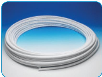
Das PB-Rohr ist ein Mehrschicht-Verbundrohr mit 5 Schichten. Die innere und äußere Kunststoffschicht bestehen aus Polybutylen. Die dazwischenliegende Sauerstoffsperrschicht wird aus EVOH-Kunststoff hergestellt, die mittels Haftvermittler - während des Fertigungsprozesses - mit den Polybutylenschichten verklebt wird. Sauerstoffdicht nach DIN 4726.
